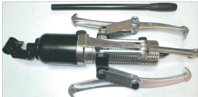
Съемники гидравлические со встроенным гидравлическим насосом предназначены для демонтажа шкивов, подшипников, втулок и других деталей, имеющих посадку с натягом.
